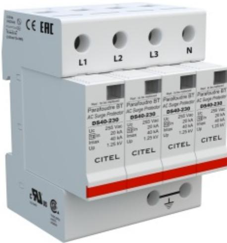
Überspannungsschutz für T2-Wechselstromnetze - CITEL AC-DS44-230 arbeitet mit vier Entladegeschwindigkeiten mit einem Strom von  $I_n = 20 \text{ kA}$  ( $8/20\mu\text{s}$ ) und verwendet einen Varistorblock als Hauptschutzelement in jedem Modul. Entwickelt für die Installation in Niederspannungs-Schalttafeln als zweite Stufe zum Schutz vor induzierten Überspannungen. Es ist auch in einer Version mit Fernsignalisierungsmöglichkeit (-S) erhältlich.
