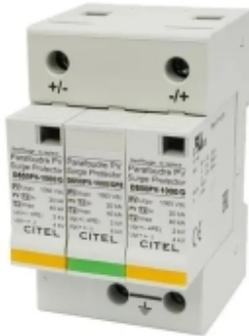
Überspannungsschutz für Gleichstromnetze Typ 2 DS50PV-1000, ausgestattet mit einer Y-Verbindungskonfiguration, die gegen Montagefehler beständig ist. Als Schutzelemente in den Modulen wurden Varistoren verwendet. Er ist für die Installation in Gleichstrom-Verteilerkästen in Einrichtungen vorgesehen, in denen eine Betriebsspannung von bis zu 1000V DC erforderlich ist, und dient als zweite Stufe des Schutzes gegen induzierte Überspannungen.
