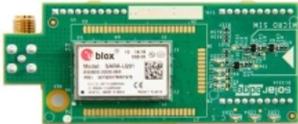
SolarEdge CELL-B-R0-GLO-V-S0 ist ein LTE/GSM-Modul mit einer Antenne (SetApp), das für sowohl private als auch kommerzielle Wechselrichter bestimmt ist. Das LTE-Plug-In ermöglicht eine drahtlose Kommunikation zwischen dem Wechselrichter und dem Überwachungsserver von SolarEdge. Das Plug-In kann direkt in den SolarEdge-Wechselrichter eingebaut und an eine externe Antenne angeschlossen werden. Dadurch wird die Kommunikationseinrichtung vereinfacht, was Zeit bei der Installation spart.
