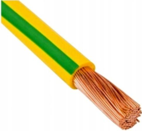
Das H07V-K LGY Kabel mit einem Querschnitt von 16 mm<sup>2</sup> und einer Spannung von 750V ist ein elektrischer Draht mit gelb-grüner Farbe, hergestellt aus einem mehrdrähtigen, flexiblen Kupferkern, isoliert mit Polyvinylchlorid (PVC). Es handelt sich um ein Niederspannungskabel, das für Verdrahtungsinstallationen konzipiert ist.
