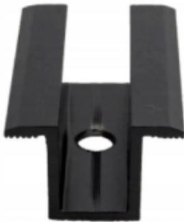
Anodisierte Mittelklemme. Sie dient zur Verbindung und Stabilisierung von Photovoltaikmodulen und gewährleistet gleichzeitig ein ästhetisches Erscheinungsbild. Abmessungen: Länge: 50 mm Höhe: 25 mm Dicke: 3 mm Farbe: schwarz Loch: M8
