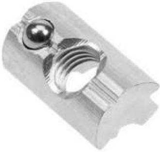
Ein Gleitstück ist eine Mutter, die eine stabile und sichere Verbindung der Mittel- und Endklemmen mit dem Profil ermöglicht. Die Kugel auf dem Gleitstück ermöglicht eine angemessene Stabilisierung und erleichtert das Positionieren der Klemme in der gewünschten Position am Montageprofil. Die Verwendung von Gleitstücken mit Kugeln zur Montage von Photovoltaik-Paneelen erleichtert erheblich den Installationsprozess.
