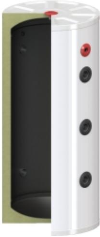
Puffer für heißes Wasser aus schwarzem Stahl, isoliert, in einem Metallgehäuse OEM BLACK v3 180 G ohne eine Spule mit einem Fassungsvermögen von 180 Litern dient zur Speicherung von heißem Kesselwasser, das dann zur Bereitstellung thermischer Energie für das Heizsystem (z.B. Fußboden-, Wand- oder Heizkörper) verwendet werden kann, wenn der Ofen oder Kessel nicht läuft. Er dient als Art von Wärmespeicher.
