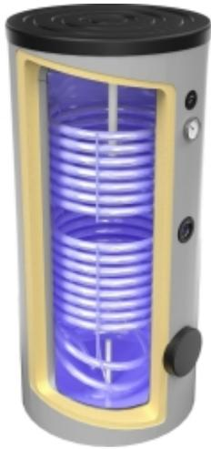
Der OEM CERAMIC V2 302 G Warmwasserbereiter mit 2 Wärmetauschern ist ein emaillierter Behälter, der zur Speicherung und Erwärmung von Brauchwasser (C.W.U.) mittels einer Spirale oder eines Elektroheizgeräts für soziale und Haushaltszwecke dient. Er ist so konzipiert, dass er den Bedarf an Warmwasser für einen Zeitraum von 24 bis 48 Stunden, abhängig von der verwendeten Wärmequelle, deckt.
