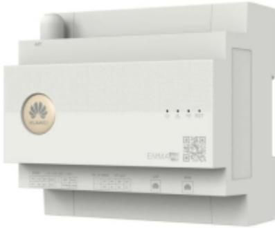
HUAWEI Energy Management Assistant (EMMA-A02) ist eine fortschrittliche Lösung, die Energiemanagement, Verbrauchsmessung und Kommunikation mit anderen Geräten in einem System integriert. Es ist eine innovative Kombination aus Software- und Hardwaretechnologie, unterstützt durch künstliche Intelligenz, die die Optimierung der Energienutzung in intelligenten Häusern ermöglicht.
