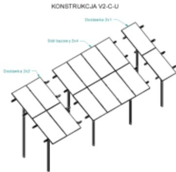
Die Stalex Zweistützige Bodenstruktur – Erweiterung 2Vx1 ist ein robustes und vielseitiges Montagesystem, das als Erweiterung für ein bestehendes 2x4-System konzipiert wurde. Es ermöglicht das Hinzufügen weiterer Photovoltaikmodule und bietet Flexibilität und einfache Installation.
