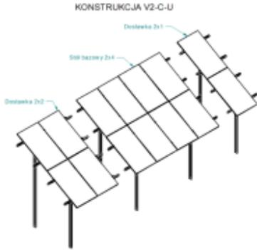
Die Stalex Zweistützige Bodenstruktur – Erweiterung 2Vx2 ist ein robustes und vielseitiges Montagesystem, das als Erweiterung für ein bestehendes 2x4-System konzipiert wurde. Es ermöglicht das Hinzufügen weiterer Photovoltaikmodule und bietet Flexibilität und einfache Installation.
