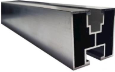
Das Aluminiumprofil 40x40 mit einer Sechskantschraube und den Abmessungen L: 4800mm besteht aus Aluminium. Seine Hauptanwendung besteht darin, die Installation von Photovoltaikmodulen mithilfe von mittleren und Endklemmen zu ermöglichen.
