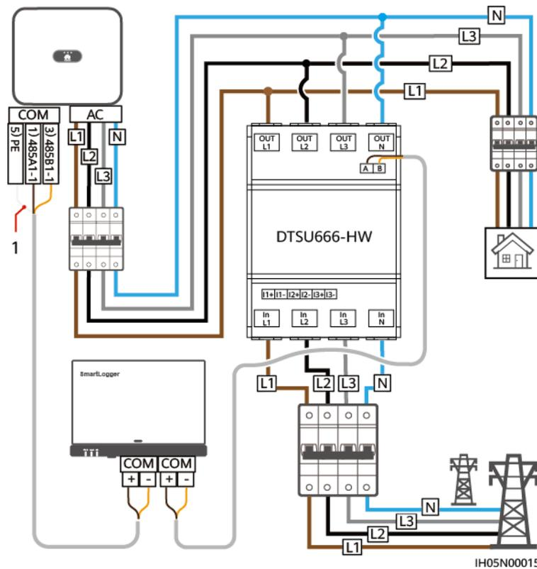
(1) Abschirmungsschicht des Signalkabels
