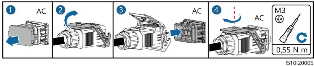
**Schritt 3** Überprüfen Sie die Verlegung des AC-Ausgangsstromkabels.
