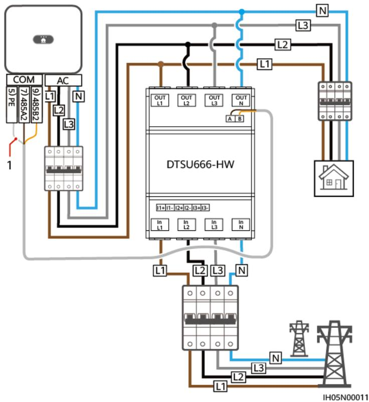
(1) Abschirmungsschicht des Signalkabels
