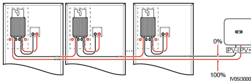
**Schritt 4** Schalten Sie den DC-Schalter auf „OFF“ und überprüfen Sie, ob die Steckverbinder oder das DC-Kabel zwischen den möglichen defekten PV-Modulen und den entsprechenden Optimierern bzw. die Steckverbinder und das DC-Kabel zwischen den benachbarten PV-Modulen und den entsprechenden Optimierern beschädigt sind.
