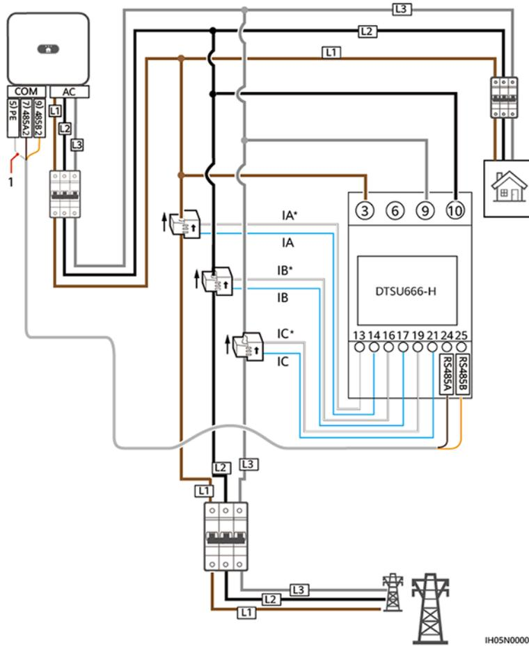
(1) Abschirmungsschicht des Signalkabels
