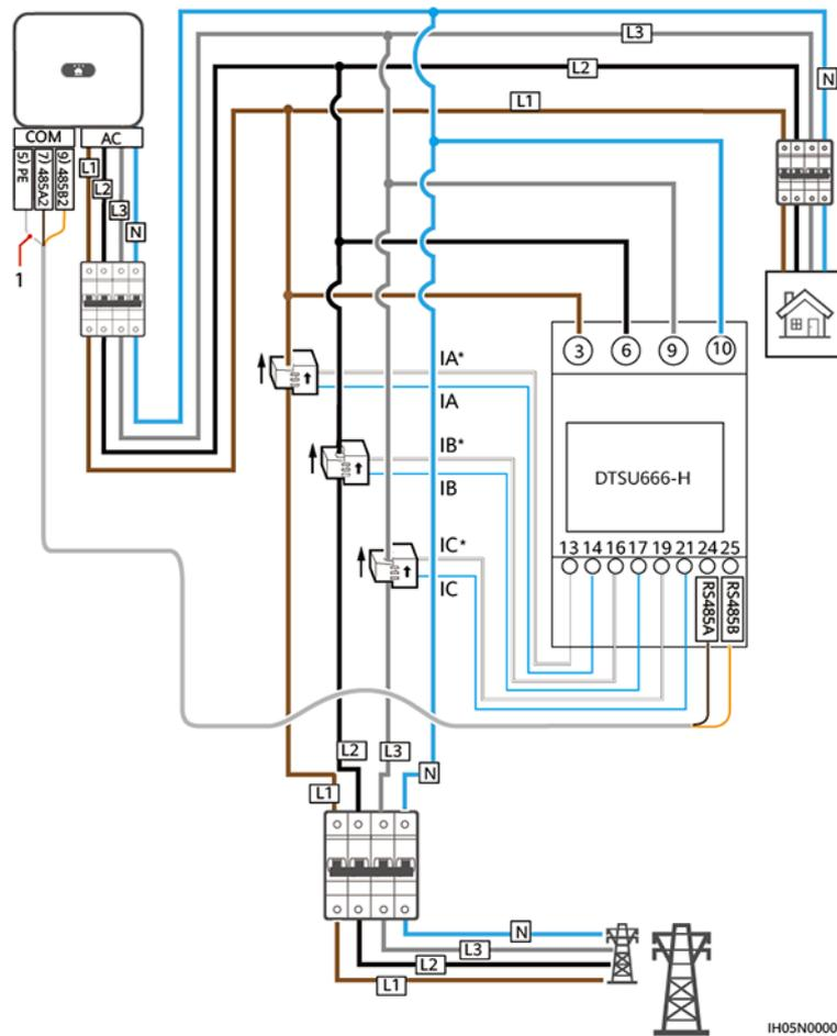
(1) Abschirmungsschicht des Signalkabels
