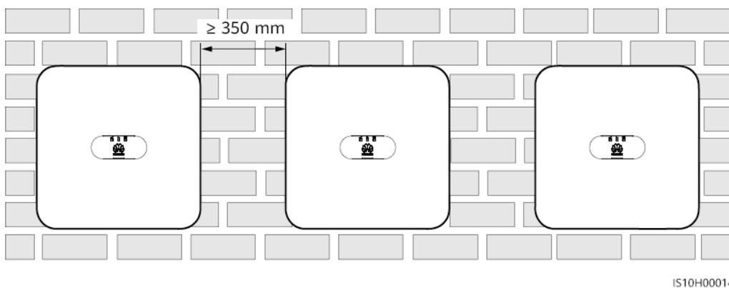
Abbildung 4-4 Versetzte Montage (empfohlen)
