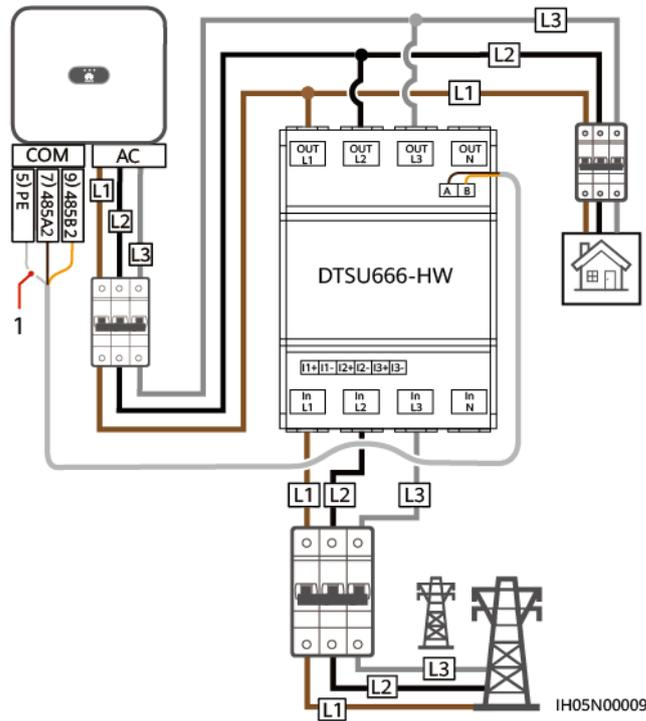
(1) Abschirmungsschicht des Signalkabels
