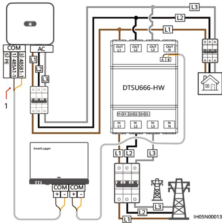
(1) Abschirmungsschicht des Signalkabels
