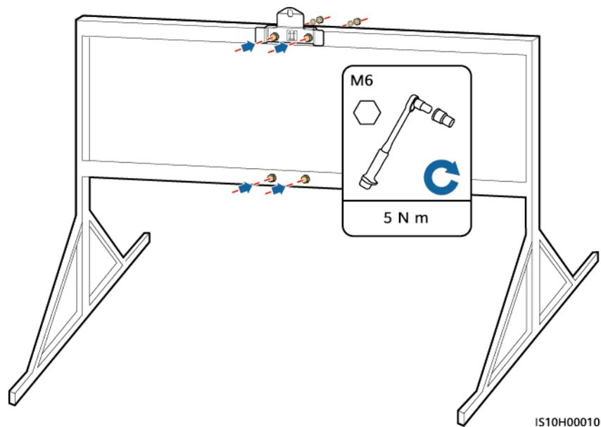
**Schritt 4** (Optional) Bringen Sie die Sicherungsschraube für den DC-Schalter an.
