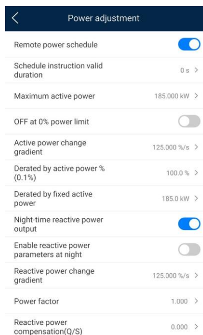
Rysunek 7-13 Parametry regulacji mocy (specjalny użytkownik)
