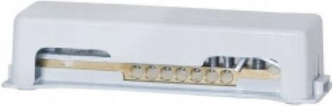
Le rail d'égalisation de potentiel 7x25, 1x50, 30x4 est un dispositif utilisé pour protéger les installations électriques et les systèmes de protection contre la foudre contre les surtensions incontrôlées. Il est monté en permanence sur un rail. Le produit comprend un câble plat mesurant 30x4 mm, sept câbles simples ou multibrins d'une section transversale allant jusqu'à 25 mm<sup>2</sup>, et un câble rond d'une section transversale de 50 mm<sup>2</sup>.
