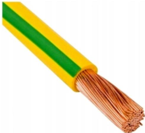
Le câble H07V-K LGY d'une section de 6 mm<sup>2</sup> et d'une tension de 750V est un fil électrique de couleur jaune-vert, constitué d'un noyau en cuivre multibrin flexible, isolé avec du chlorure de polyvinyle (PVC). Il s'agit d'un câble basse tension conçu pour les installations électriques.
