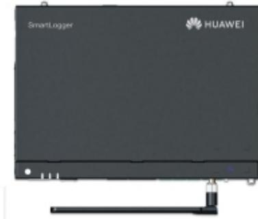
HUAWEI Smart Logger 3000 A03EU (MBUS, 4G) est un dispositif avancé de surveillance et de gestion des installations photovoltaïques. Il centralise tous les ports, convertit les protocoles, collecte et stocke les données, et assure la surveillance et la maintenance centralisées des appareils dans les installations PV.
