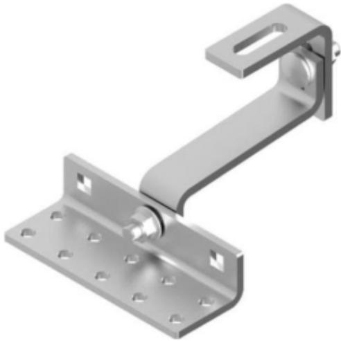
Le crochet de toit VARIO avec double réglage, d'une longueur de 150 mm et fabriqué en matériau Magnelis, est une solution idéale pour le montage sur les toits recouverts de tuiles en béton ou en céramique. Grâce à sa conception et à l'utilisation du matériau innovant Magnelis, ce crochet offre une durabilité exceptionnelle et une résistance aux conditions météorologiques. Le crochet est en acier inoxydable.
