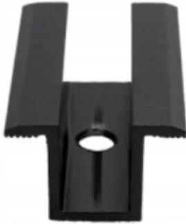
Pince centrale anodisée. Utilisée pour la connexion et la stabilisation des modules photovoltaïques tout en assurant un aspect esthétique. Dimensions : longueur : 50 mm hauteur : 25 mm épaisseur : 3 mm couleur : noir Trou : M8
