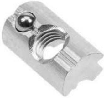
Un insert coulissant est un écrou qui permet une connexion stable et sécurisée des pinces centrales et des pinces d'extrémité au profil. La bille située sur l'insert permet une stabilisation adéquate et facilite le positionnement de la pince dans la position souhaitée sur le profil de montage. L'utilisation d'inserts coulissants avec des billes pour le montage des panneaux photovoltaïques simplifie considérablement le processus d'installation.
