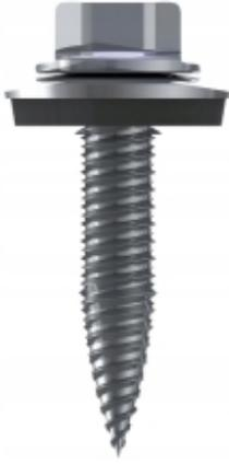
Vis autotaraudeuse 6x25 en acier inoxydable (bi-métal) avec rondelle EPDM Reisser - une vis bimétallique pour tôles minces. La vis autotaraudeuse est utilisée pour fixer des profilés et des tôles sur des structures en acier et en aluminium. Utile pour l'installation de structures photovoltaïques.
