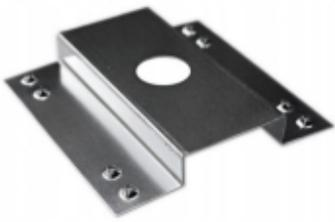
La rondelle de contact, également connue sous le nom de plaque de mise à la terre de type A2, est un composant de montage utilisé dans les installations photovoltaïques. Sa fonction principale est d'égaliser les potentiels entre le cadre, la structure et les panneaux photovoltaïques, assurant ainsi la continuité des connexions galvaniques dans l'ensemble de l'installation solaire.
