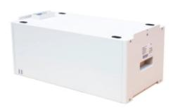
BATTERIE BYD BOX PREMIUM HVM - batterie haute tension avec une technologie de cellules au phosphate de fer lithium. Le kit BYD Premium HVM connecte de 3 à 8 modules de batterie connectés en série. La capacité utile du kit varie de 8,3 kWh à 22,1 kWh. BYD HVM permet la création d'une connexion directe de 3 ensembles de Battery-Box Premium HVM en disposition parallèle, assurant une capacité maximale du kit de 66,2 kWh.
