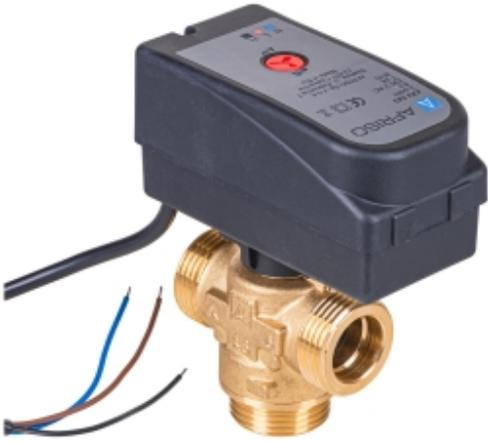
La vanne 3 voies pour les pompes à chaleur 6-10 kW HP 3WV KAISAI est un dispositif de commutation utilisé dans les systèmes de chauffage, de refroidissement et d'eau chaude sanitaire. Elle est installée pour rediriger le flux entre deux installations différentes. Contrôlée par un signal SPST, elle peut être activée par n'importe quel thermostat ou interrupteur. Cette vanne est spécifiquement conçue pour les pompes à chaleur KAISAI d'une puissance de 6 à 10 kW.
