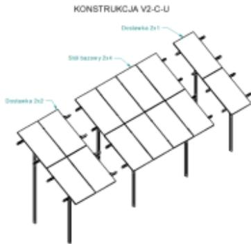
La structure au sol à double support Stalex – Extension 2Vx2 est un système de montage robuste et polyvalent conçu comme une extension d'un système existant 2x4. Elle permet l'ajout de modules photovoltaïques supplémentaires, offrant flexibilité et facilité d'installation.
