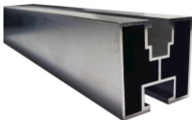
Le profilé en aluminium 40x40 avec une vis hexagonale et des dimensions L: 4800mm est fabriqué en aluminium. Son principal usage est de permettre l'installation de panneaux photovoltaïques à l'aide de pinces centrales et finales.
