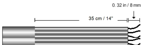
Ilustracja 39: Usuwanie izolacji – AC
