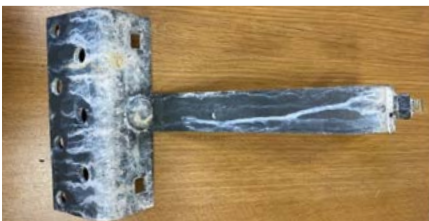
fot 5. Zdjęcie po pełnym cyklu 720 h magnelis wraz ze śrubą w ocynku ogniwym.
