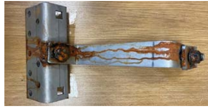
fot 6. Zdjęcie po pełnym cyklu 720 h próbka stali kwasoodpornej 1.4301 wraz ze śrubą nierdzewną A2.
