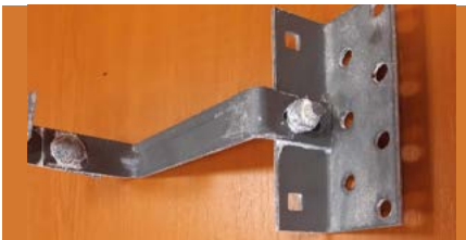
fot 3. Zdjęcie po 320 h magnelis wraz ze śrubą w ocynku ogniwym.
