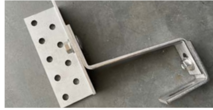
fot 2. Zdjęcie przed włożeniem do komory solnej próbka stali kwasoodpornej 1.4301 wraz ze śrubą nierdzewną A2
