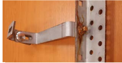
fot 4. Zdjęcie po 320 h próbka stali kwasoodpornej 1.4301 wraz ze śrubą nierdzewną A2.
