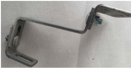
fot 1. Zdjęcie przed włożeniem do komory solnej próbka magnelis wraz ze śrubą w ocynku ogniwym.
